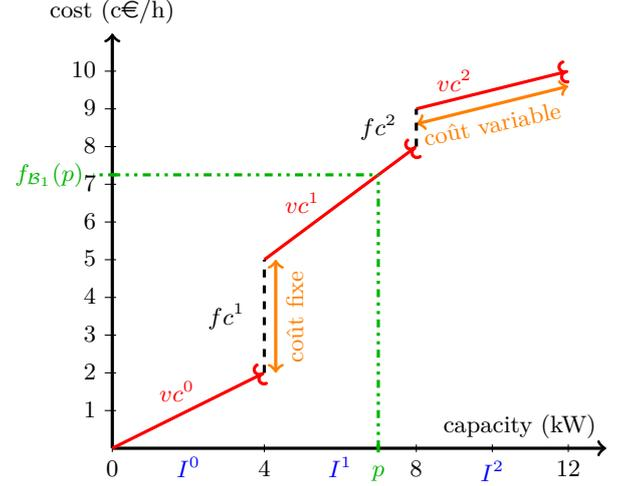
FIG. 2 – Fonction de coût électrique dans un calendrier  $B_l$ .
